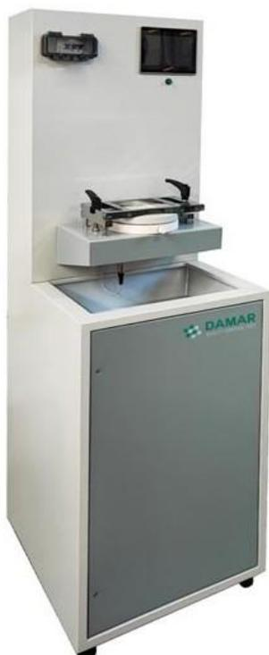
Il test della colonna d'acqua determina il grado di resistenza alla penetrazione d'acqua (impermeabilità) per tutti i tessuti impermeabili, attraverso un incremento costante (cm/min) della pressione idrostatica generata dall'azionamento dei propulsori interni fino a 20m H2O.
